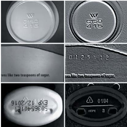
РИС. 2. ▲ Технология Surface FX определяет рельефные и тисненые дефекты на деталях
